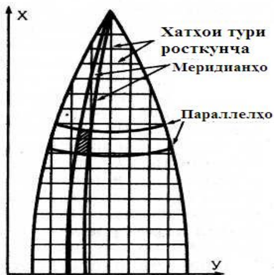
Расми 2.14. Схеми ҷойгиршавии варақи харита (штрихонида шудааст) ва хатҳои тури координатии росткунҷа дар ҳудуди зонаи Гаусс-Крюгер
