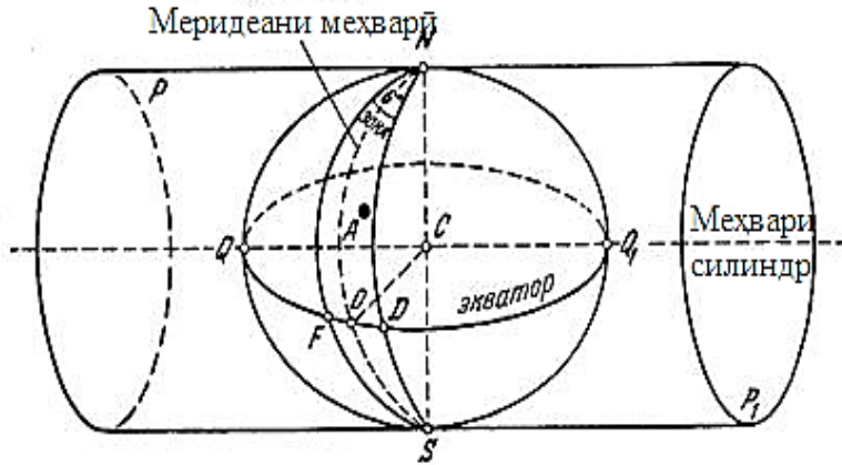
Расми 2.10. Проексияи кундаланги цилиндрии Гаусс-Крюгер
