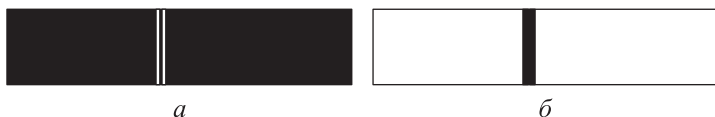
Рис. 327. Спектр испускания (а) и спектр поглощения (б) пара натрия (схематическое изображение). Рисунок имеет цветной дубликат (см. форзац)
