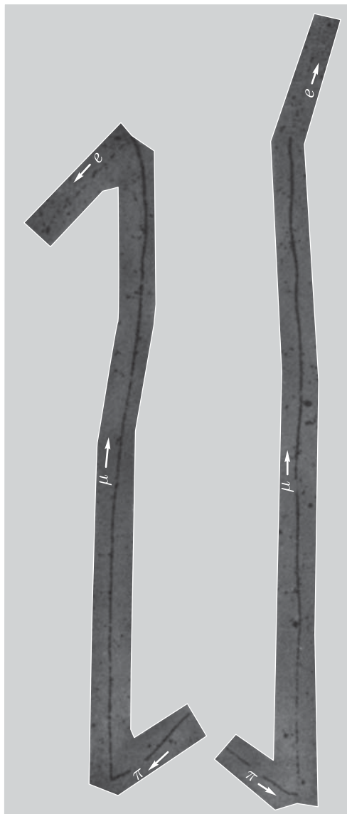
Рис. 415. Два случая распада \pi -мезона, зарегистрированные в фотоэмульсии. \pi -мезон останавливается и распадается по схеме \pi \rightarrow \mu + \nu (левая часть снимка); нейтринно следа не оставляет. Образовавшийся мюон, пройдя путь около 0,6 мм, также останавливается и распадается по схеме \mu \rightarrow e + 2\nu . Быстрые частицы слабее ионизируют и образуют менее плотные следы — ср. след электрона и начальный участок пути мюона. Заряды частиц в данном опыте определить нельзя, но скорее всего они положительные: в фотоэмульсиях \pi^- -мезоны обычно поглощаются ядрами, не успевая распасться. Напротив, \pi^+ -мезоны ядрами отталкиваются и им после торможения остается только распасться
