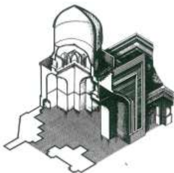
Рис. 22. Аксонометрический разрез медресе-мечети Кук-Гумбаз в Истаравшане
