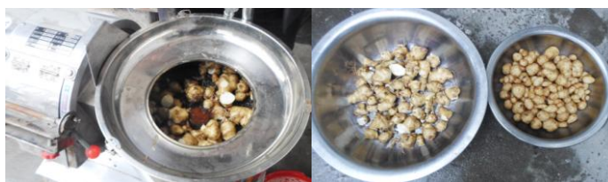
Расми 29. Мошинаи коркарди лӯндаҳои топинамбур тағмаи MQ-10 (аз чап), лӯндаҳо пеш аз коркард бо мошина (дар мобайн) ва лӯндаҳо баъди коркард бо ёрии мошина (аз рост).
