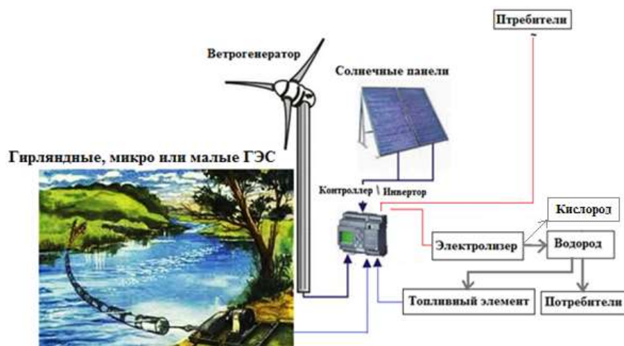
сунок 1. Принципиальная схема подключения электролизера к системе возобновляемых источников энергии.
